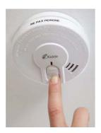
Un DAAF est constitué d'une lampe émettant un rayon lumineux vers une diode photoélectrique. Lorsqu'un obstacle vient se mettre dans le champ, en l'occurrence ici, de la fumée, le rayon ne peut plus atteindre la diode, ce qui déclenche automatiquement un signal sonore d'au moins 85 décibels. En fait, le DAAF fonctionne sur le même principe qu'un détecteur de mouvement sauf que l'alarme n'est pas déclenchée par une personne mais par de la fumée.
